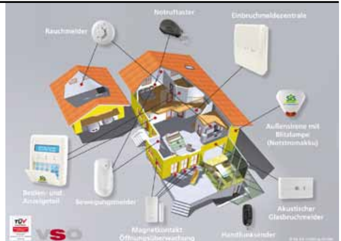
◆ Das intelligente SiS Haus: Alarm, Video, Zutrittskontrolle, Brandmeldeanlagen und KNX/EIB-Gebäudesteuerung SIS, FURGLER
